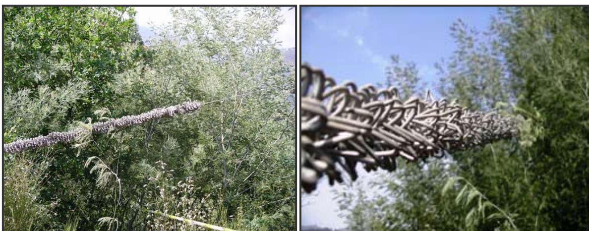
Figuras 7 & 8. Pormenores do cabo eléctrico que ficou agarrado ao patim direito
