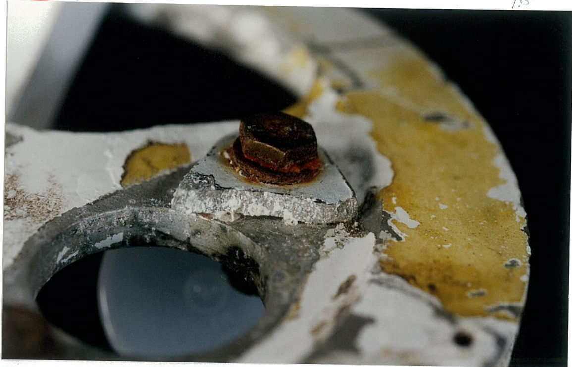
Figura 9 - Superfície de fractura no componente da figura 7 (abas de fixação do outro lado)
