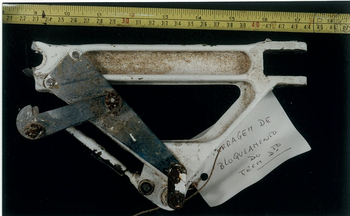
Figura 1 - Ferragem do conjunto de bloqueamento do trem direito
