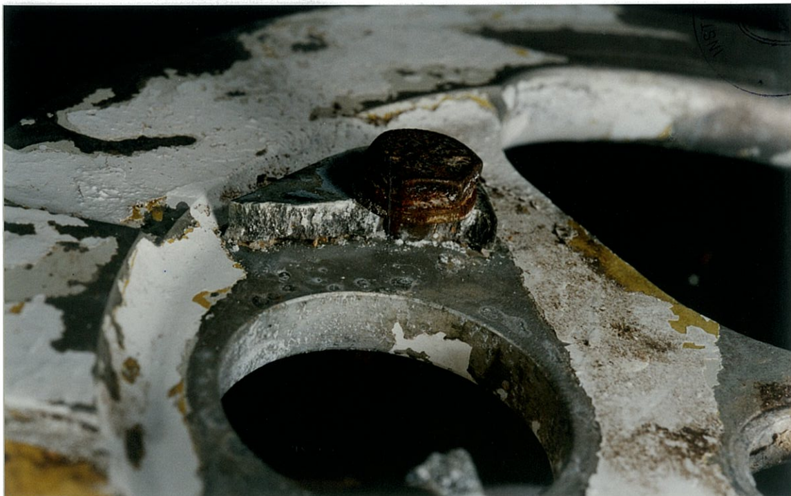
Figura 8 - Superfície de fractura no componente da figura 7 (abas de fixação)
