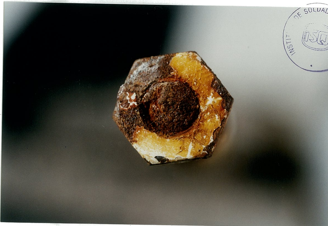
Figura 4 - Superfície de fractura do componente da figura 3.
