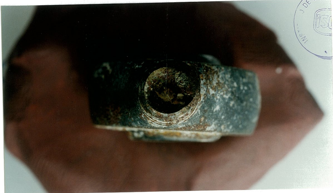
Figura 6 - Superfície de fractura do componente da figura 5.
