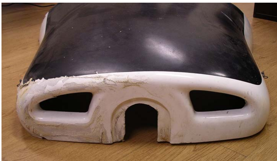
Fig2. Cobertura do motor danificada do lado direito por acção do hélice
