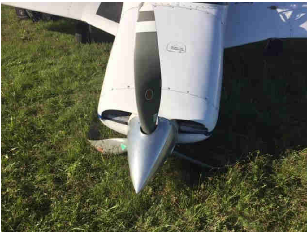
Obr. 2 Poškození vrtule na místě konečného zastavení
