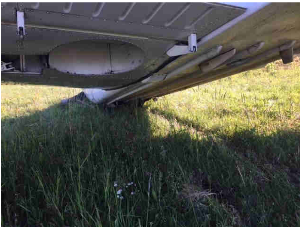
Obr. 3 Zavřený předový podvozek na místě konečného zastavení
