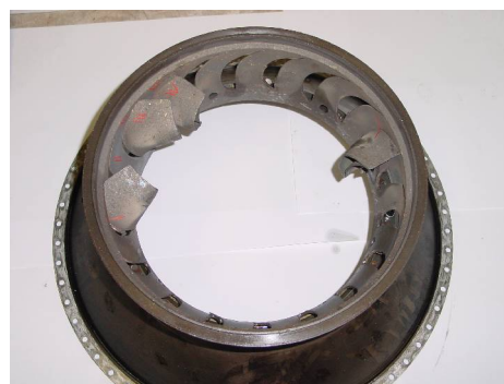
obr. 2 Poškození rozvaděče VT
