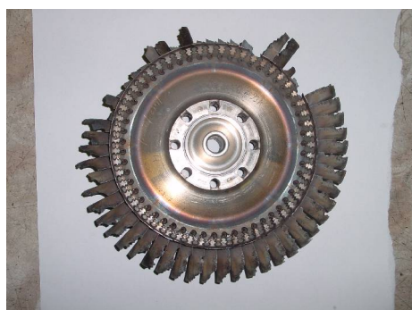
obr.1 Poškození rotoru GT
