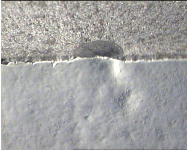
Obr. 1-10 Detail - počáteční trhлина - pohled z boku na povrch B
