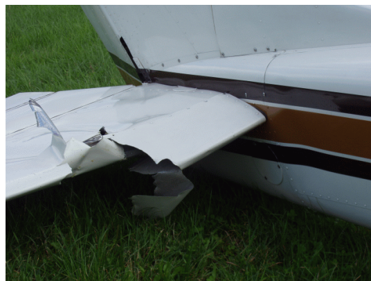
Poškození pravé poloviny VOP
