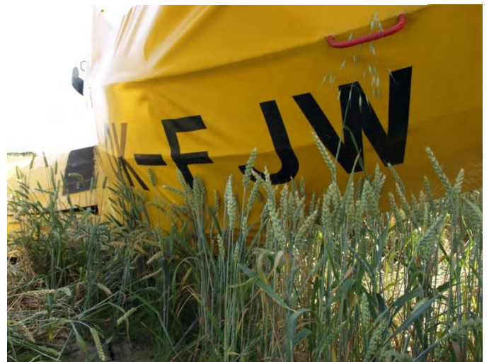
Deformace zadní zlomené části trupu
