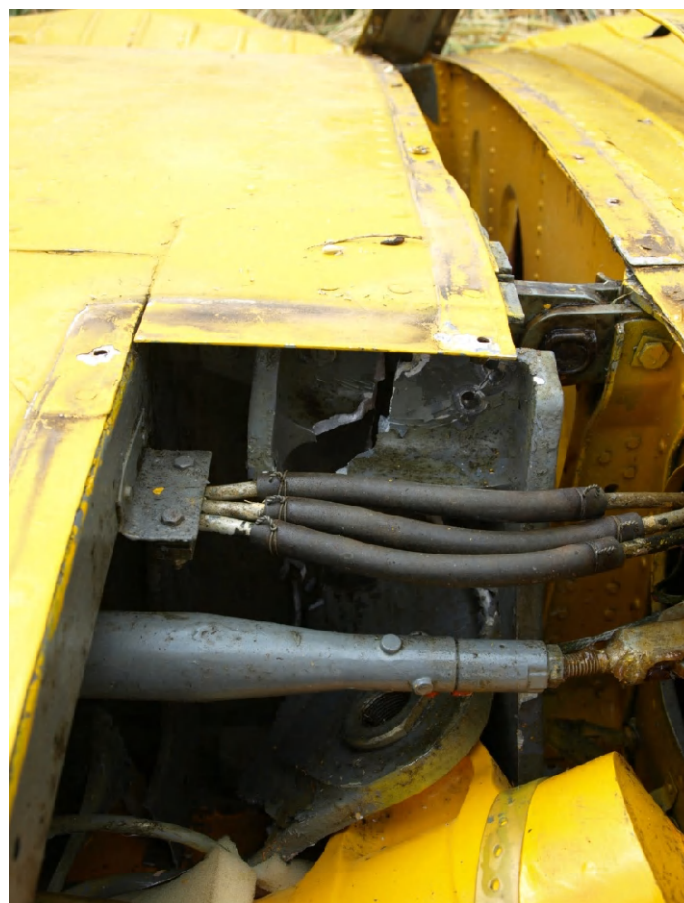
Rozlomení nosníku v místě ukotvení levé podvozkové nohy
