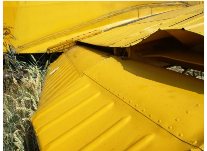
Poloha vztlakových klapek a deformace odtokové části křídla
