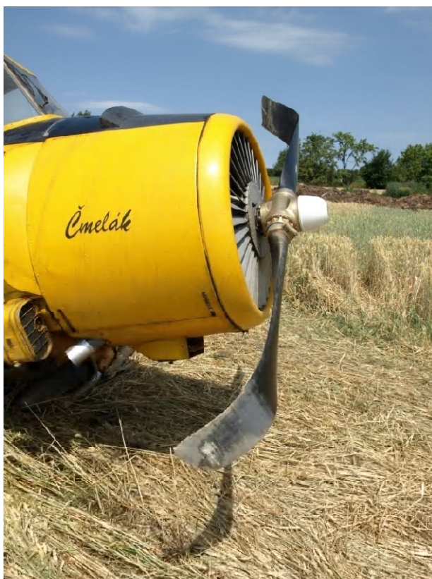
Poškození listů vrtule
