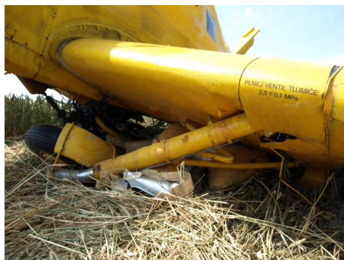
Vylomený levý hlavní podvozek
