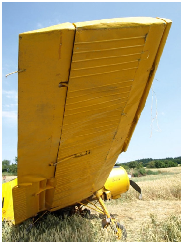
Poškození pravé vnější části křídla
