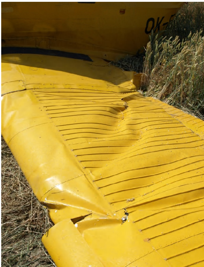
Deformace centroplánu a levé vnější části křídla
