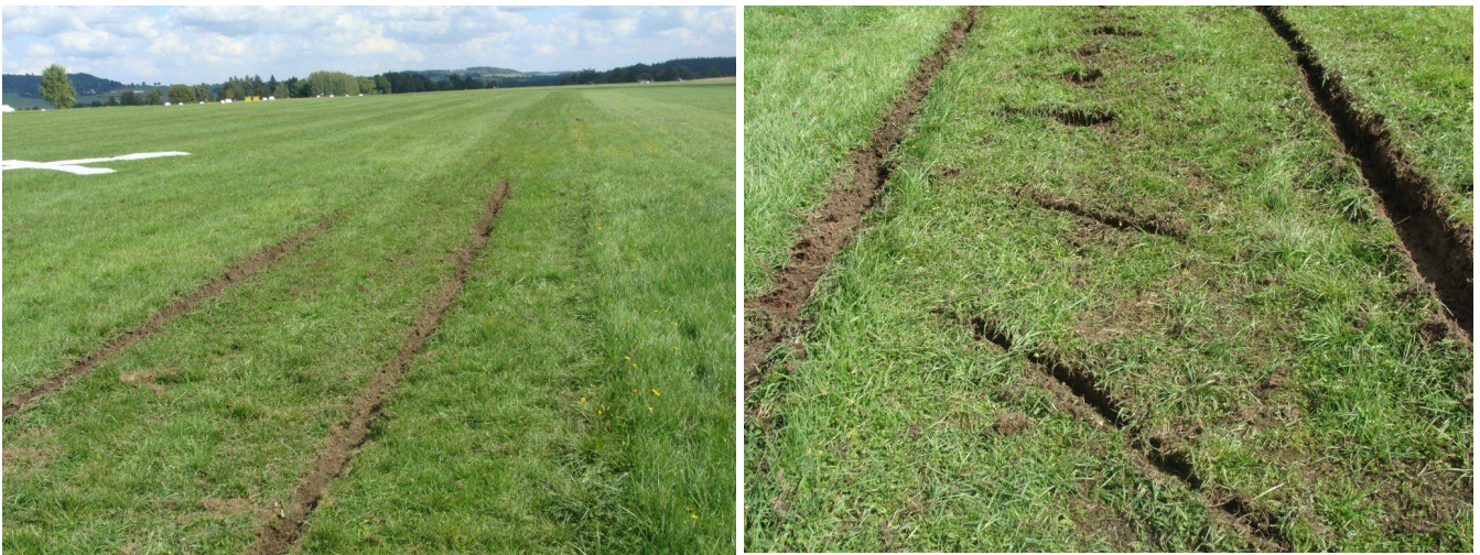
Obr. 3 Stopy dosednutí a dojezdu letounu F-GXCP
