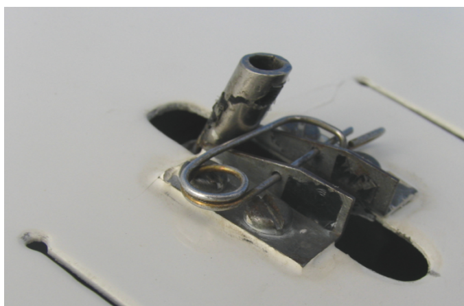
Obrázek 3 Poloha konce uzamykací páky vůči závlačce
