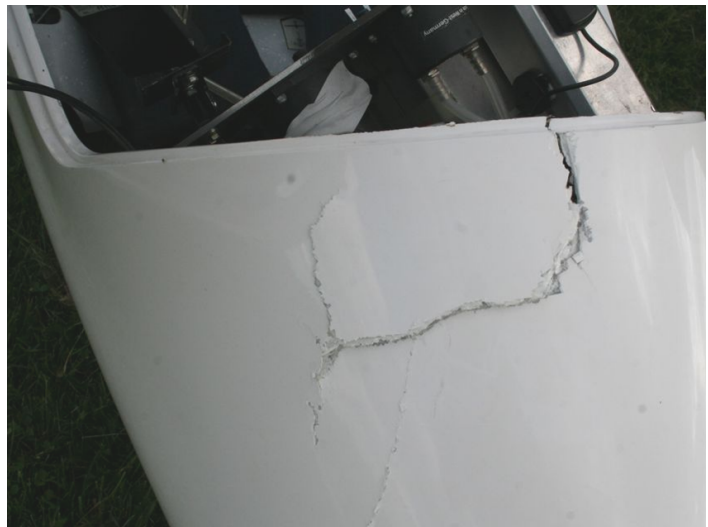
Poškození skořepiny trupu a překrytu kabiny
