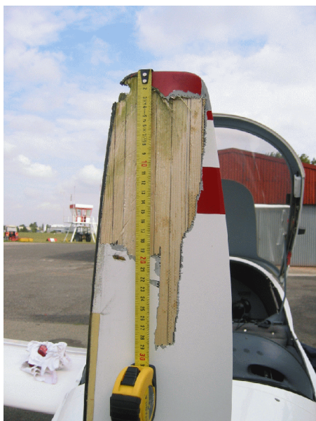
Poškození vrtulového listu č.2
