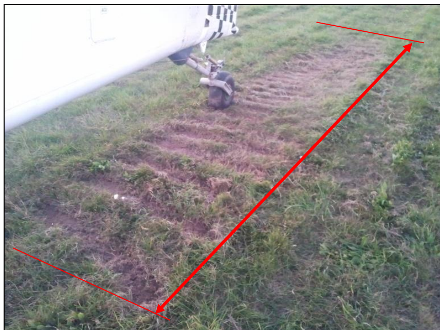
Stopy po zásecích vrtule
