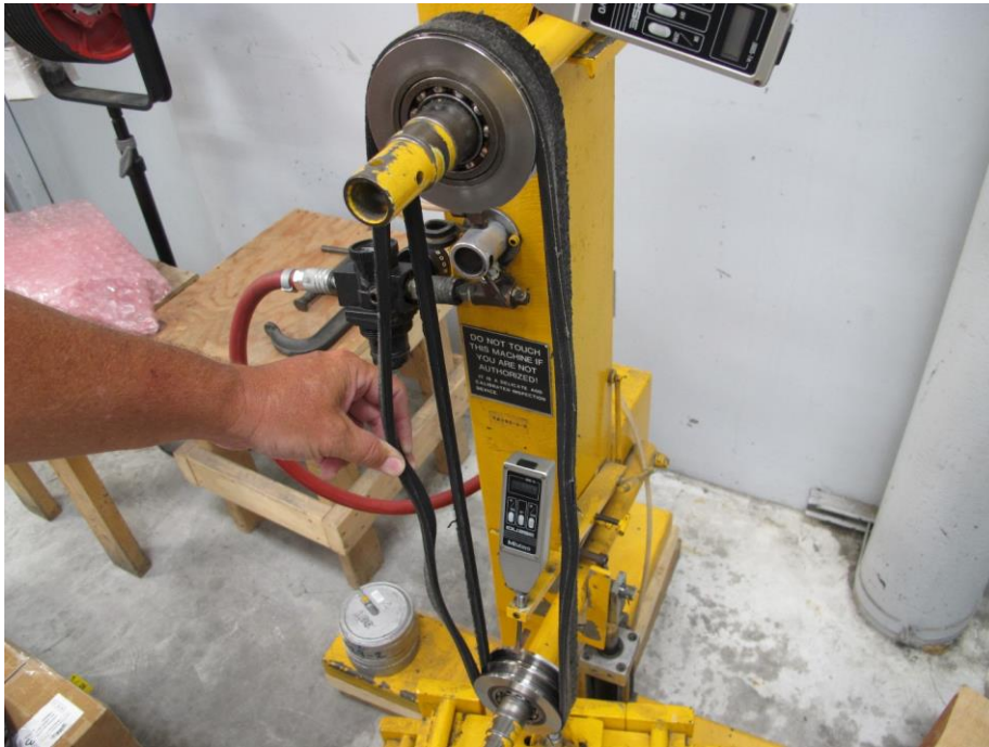
Obr.1 Řemeny v měřicím přípravku u výrobce
