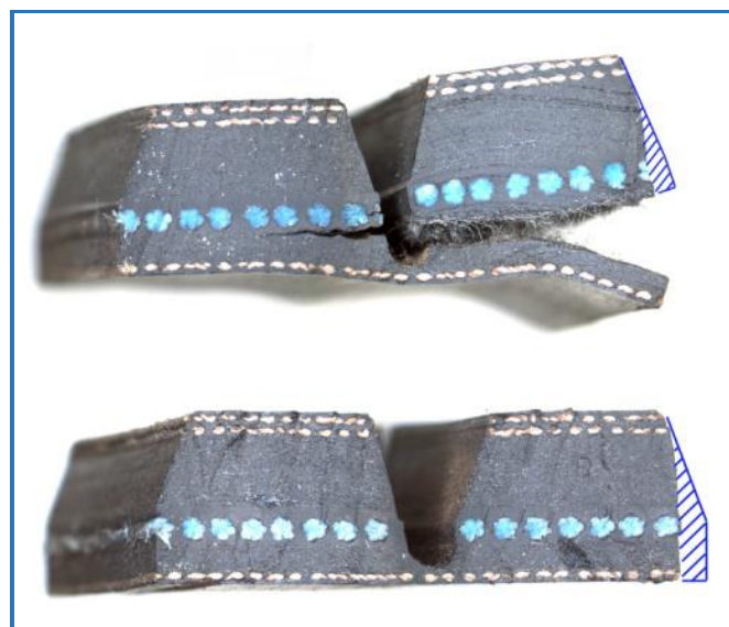
Důsledek přetížení řemene a separace spojovací vrstvy
