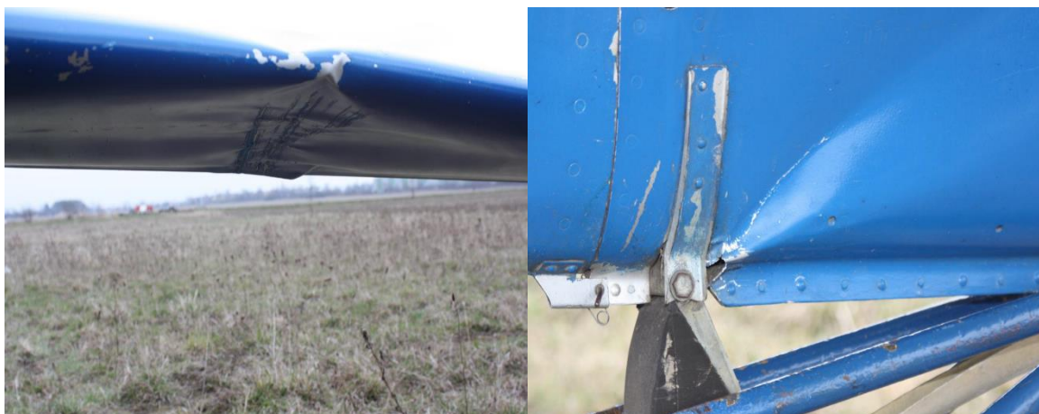
Obr. č. 1: Poškození VOP a ocasní části trupu nad ostruhou
