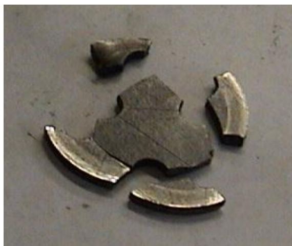
Otvor s vloženou Segerovou pojistkou a poškozené části kruhové podložky
