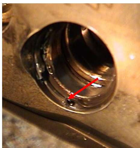
Otvor s vloženou Segerovou pojistkou a poškozené části kruhové podložky
