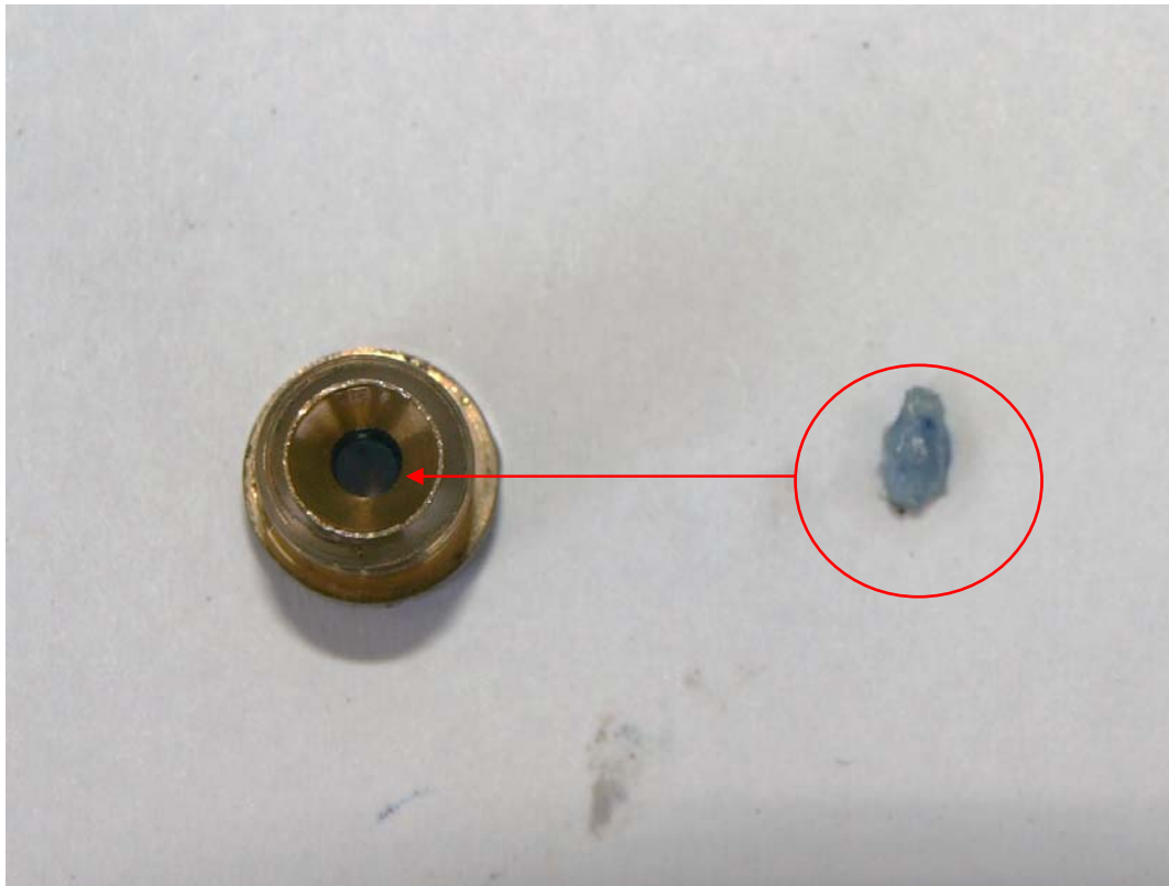
„Žmolek“ silikonové pryže nacházející se v otvoru hlavní trysky karburátoru.
