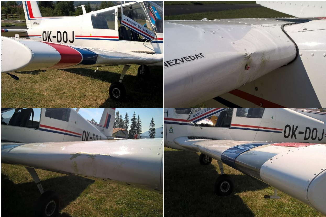
Obr. č. 2: Poškozený letoun Zlín Z 43
