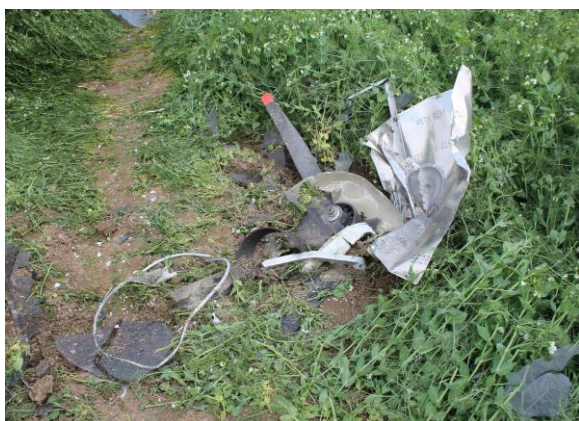
Odlomená vrtule s ozubeným kolem reduktoru
