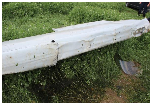
Náběžná hrana levé poloviny křídla
