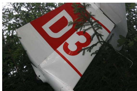
Detail poškození pravé poloviny křídla
