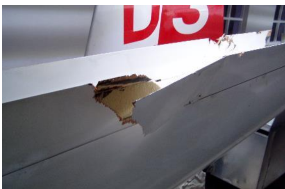
Detail poškození pravé poloviny křídla
