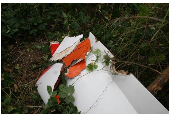
Pohled na poškozenou přední část trupu
