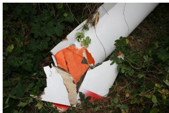
Pohled na poškozenou přední část trupu
