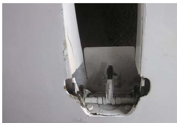
Detailní pohled na stav zavěšení plovoucí VOP
