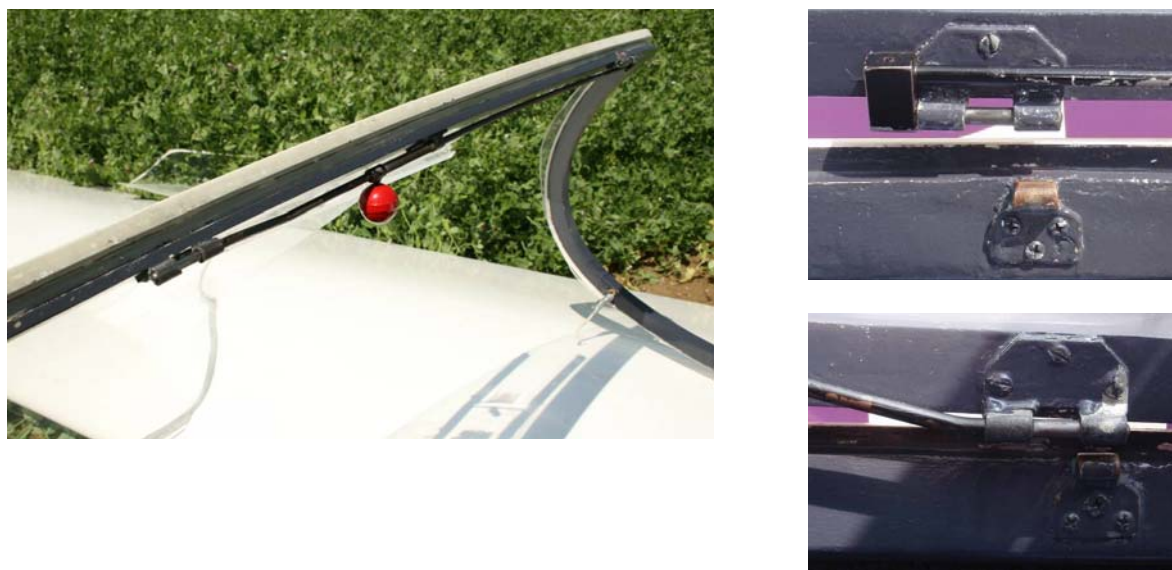
Obrázek 2 Poloha táhla v očích zámků krytu zadní kabiny
