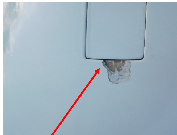
Poškození na pravé polovině křídla v místě křídélka a brzdící klapky
