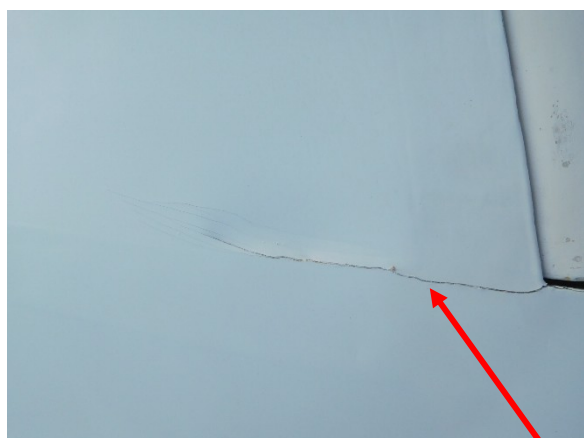
Poškození na pravé polovině křídla v místě křídélka a brzdící klapky
