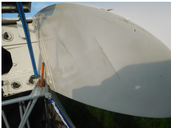
Poškození kořene levé poloviny křídla
