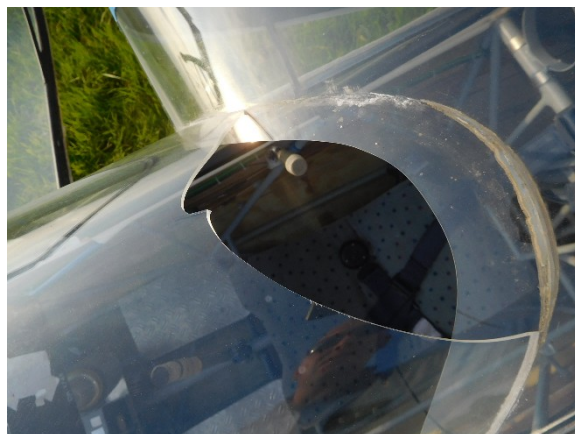
Poškození krytu kabiny
