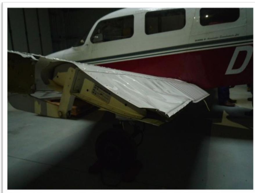
Obr. 4 Místo odtržení vnější části křídélka od levé poloviny křídla
