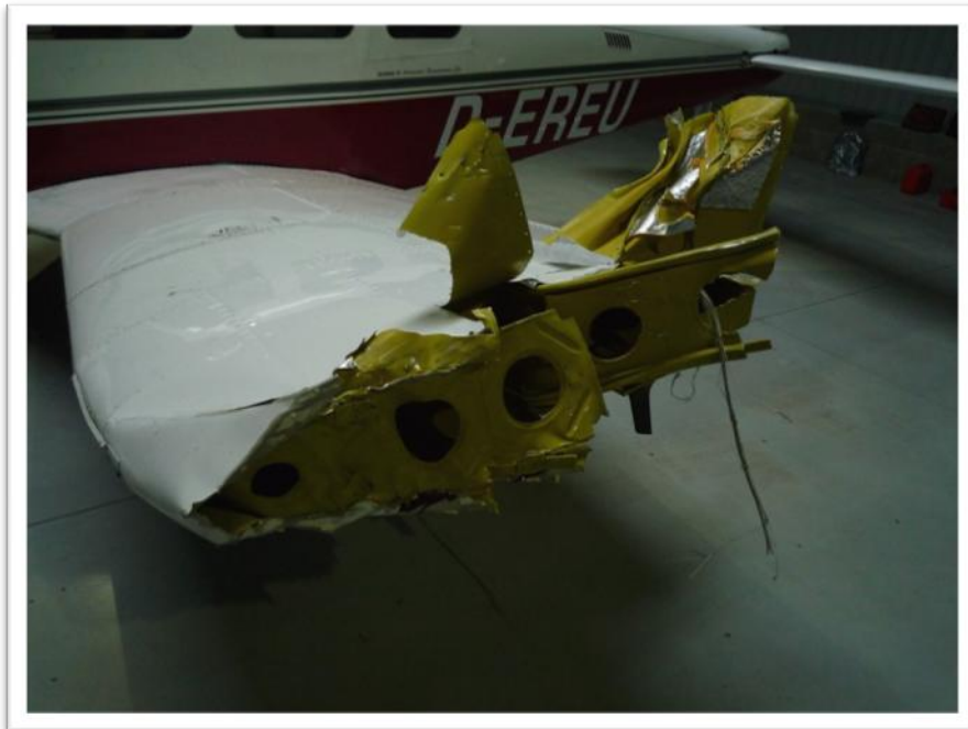
Obr. 3 Destrukce levé poloviny křídla
