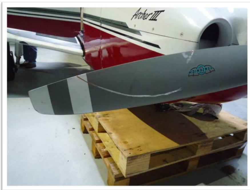
Obr. 5 Poškození listu vrtule na pravé straně
