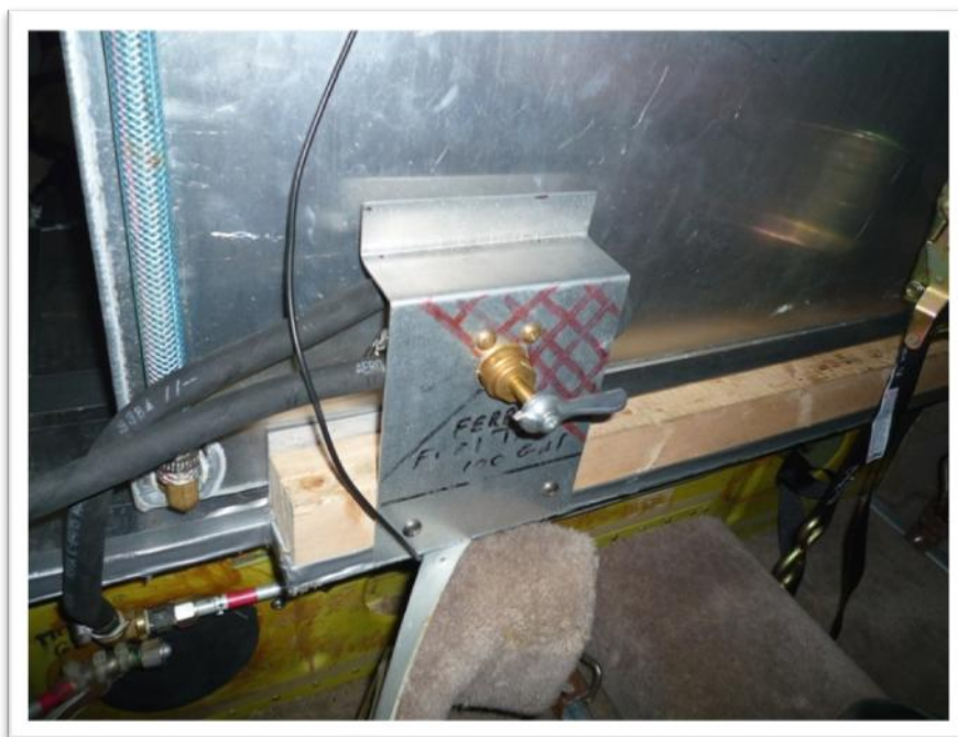
Obr. 11 Poloha páky přidavného palivového kohoutu kdy byla propojena pouze pravá křídlová nádrž s přidavnou nádrží
