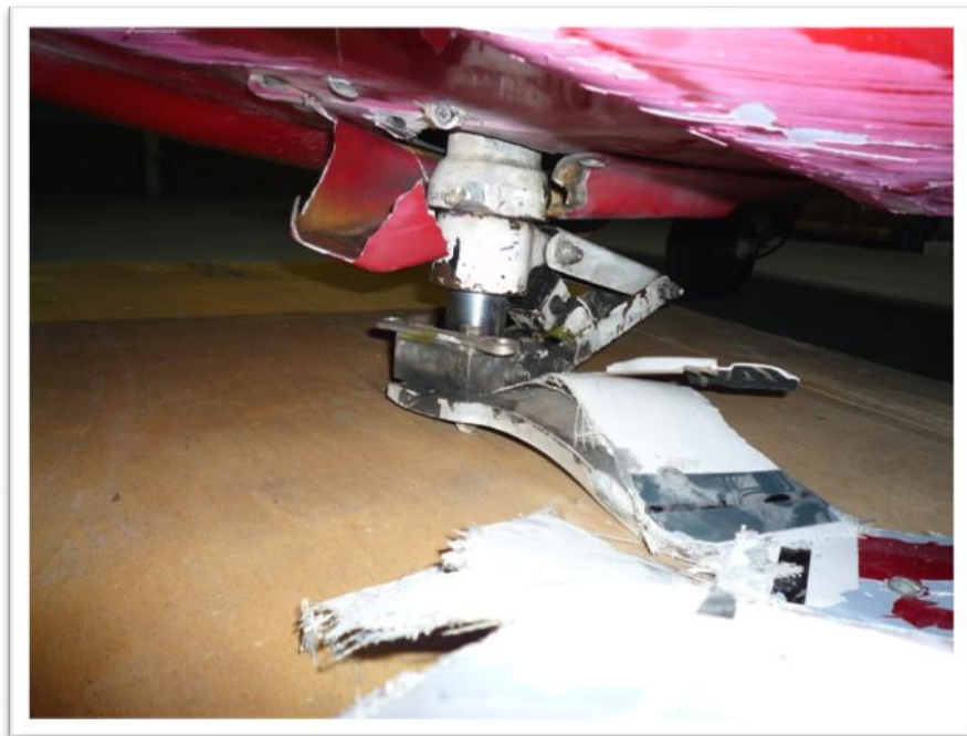
Obr. 8 Zlomená noha předového podvozku
