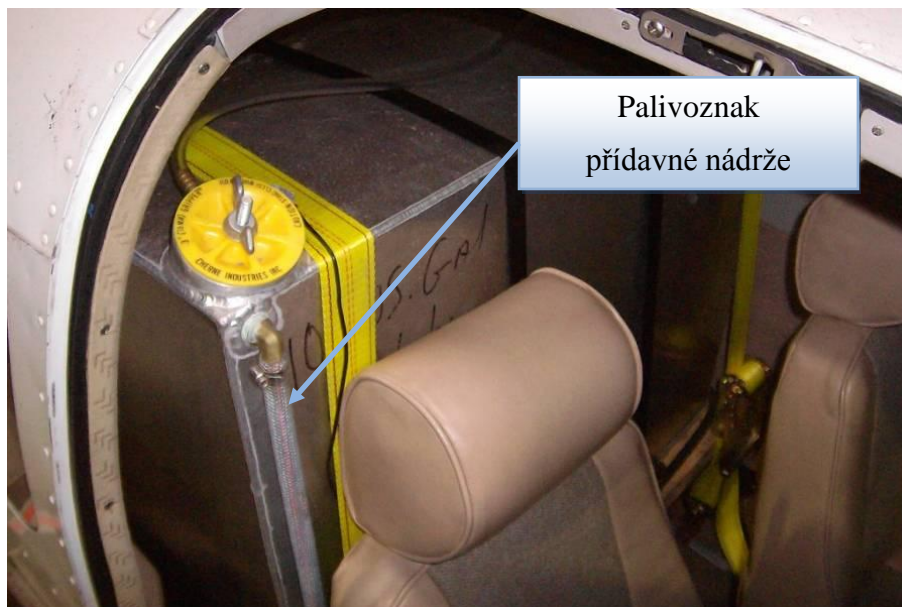
Obr. 6. Umístění přídavné palivové nádrže a palivoznaku
