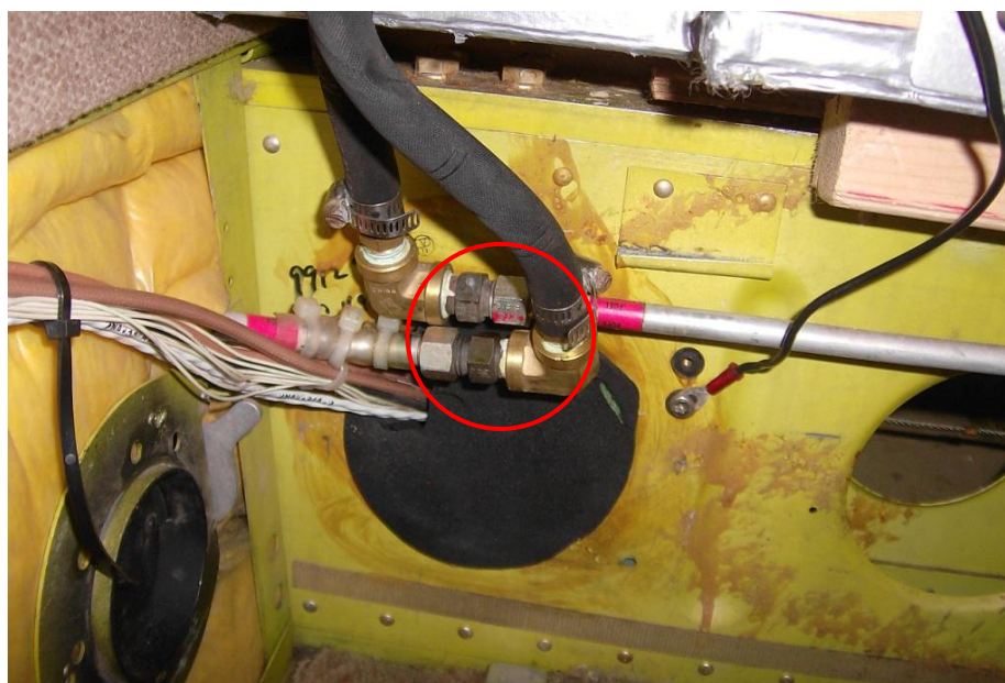
Obr. 7. Místo připojení přídavného palivového systému
