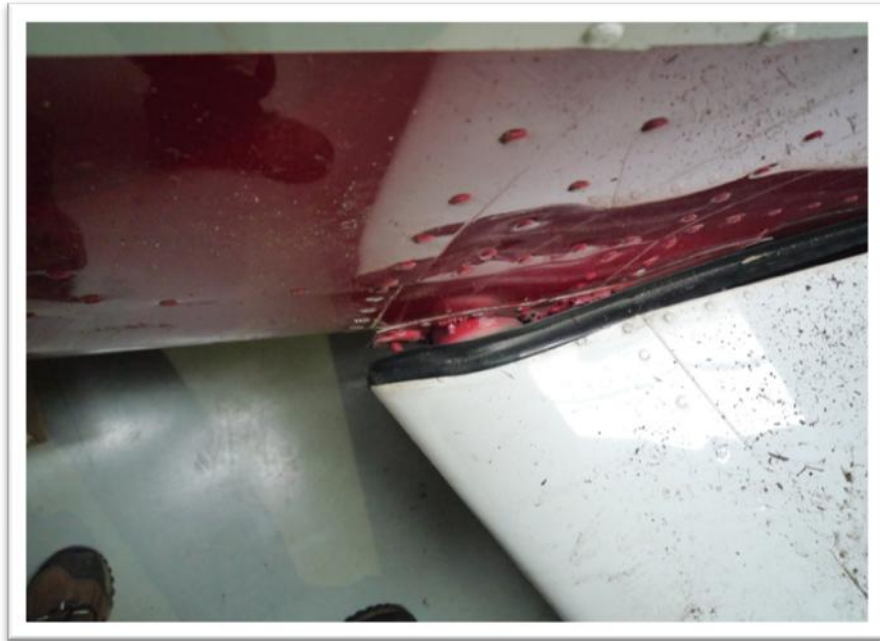
Obr. 7 Poškození vetnutí křídla u centroplánu
