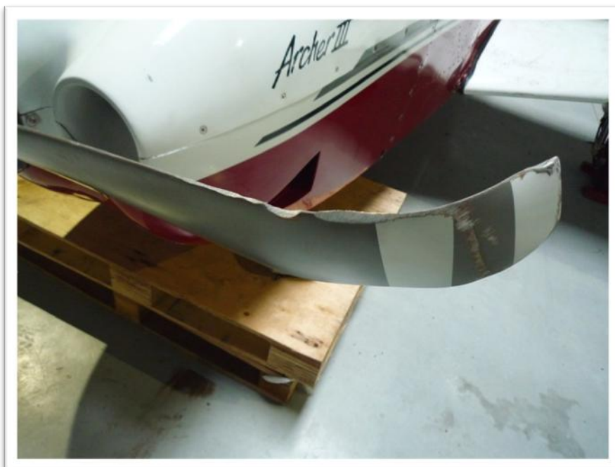
Obr. 6 Deformace listu vrtule na levé straně
