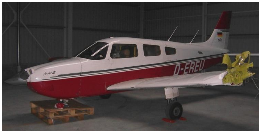
Obr. 4 Poškození letounu PA-28-181 D-EREU
