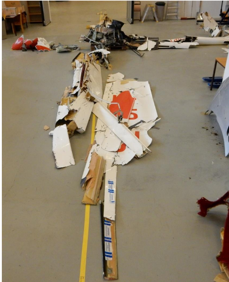
Figur 7. Bilden visar vrakdelarna utlagda på rätt position med vänster ving i förgrunden. Delarna märkta med blåvit tejp hittades på annan plats än huvudvraket. Foto: SHK.
