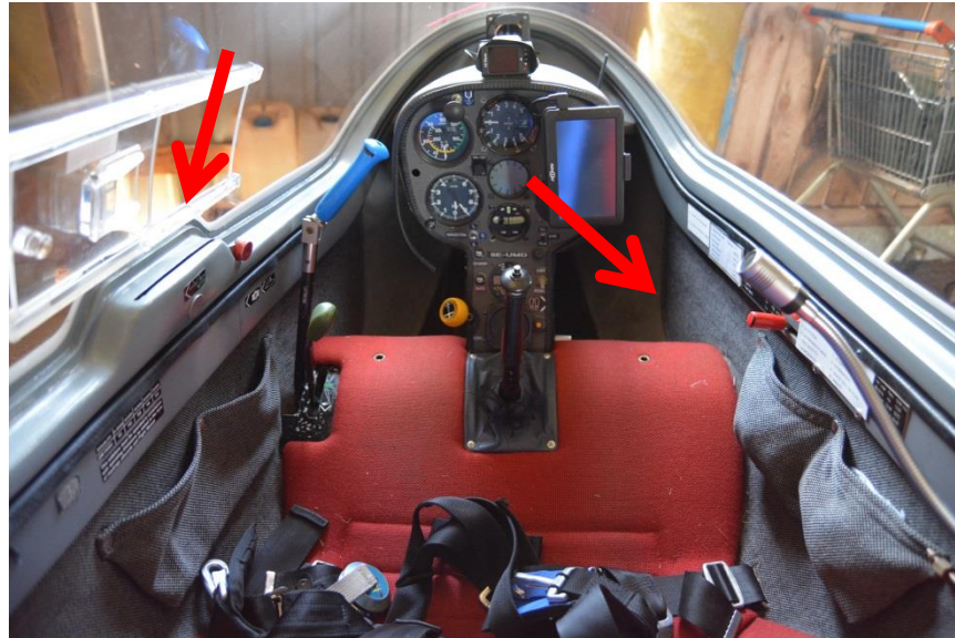
Figur 2. Pilarna visar de två nödfällningsreglagen. Foto: Henrik Svensson.
