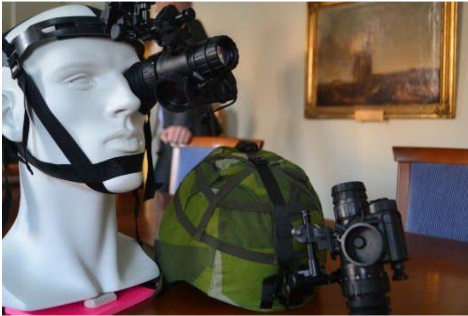
Figur 7. Bildförstärkare Mono 12/T. Foto: Therese Fagerstedt, Försvarmakten.
