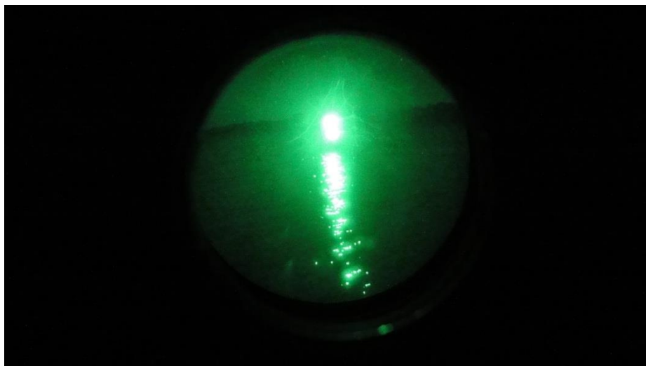
Figur 16. G-båt fotograferad genom ett bildförstärkarrör. Lanterna och instrumentbelysning är tillslagna ombord. Den automatiska förstärkningen är kraftigt neddragen men man kan urskilja att det finns två starka ljuskällor, i detta fall topp och sidolanterna vilka även speglas i vattnet. Av bakgrunden är det inte mycket som framträder.
