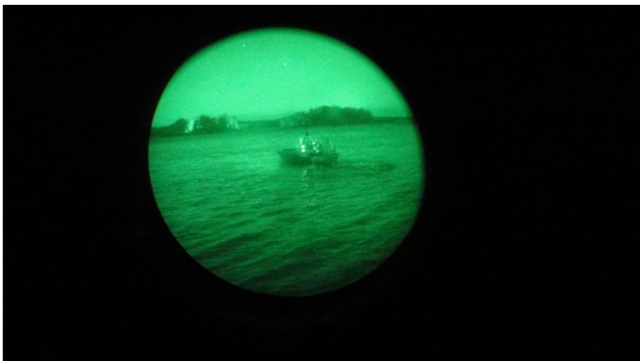
Figur 15. G-båt fotograferad genom ett bildförstärkarrör. Endast instrumentbelysning är tillslagen ombord. Förstärkningen är vid detta tillfälle något neddragen men bakgrunden framträder fortfarande ganska tydligt.
