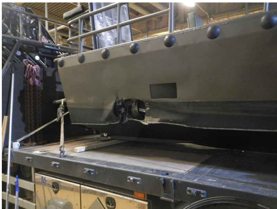
Figur 11. Skrovskada på G-båtens styrbordssida.
