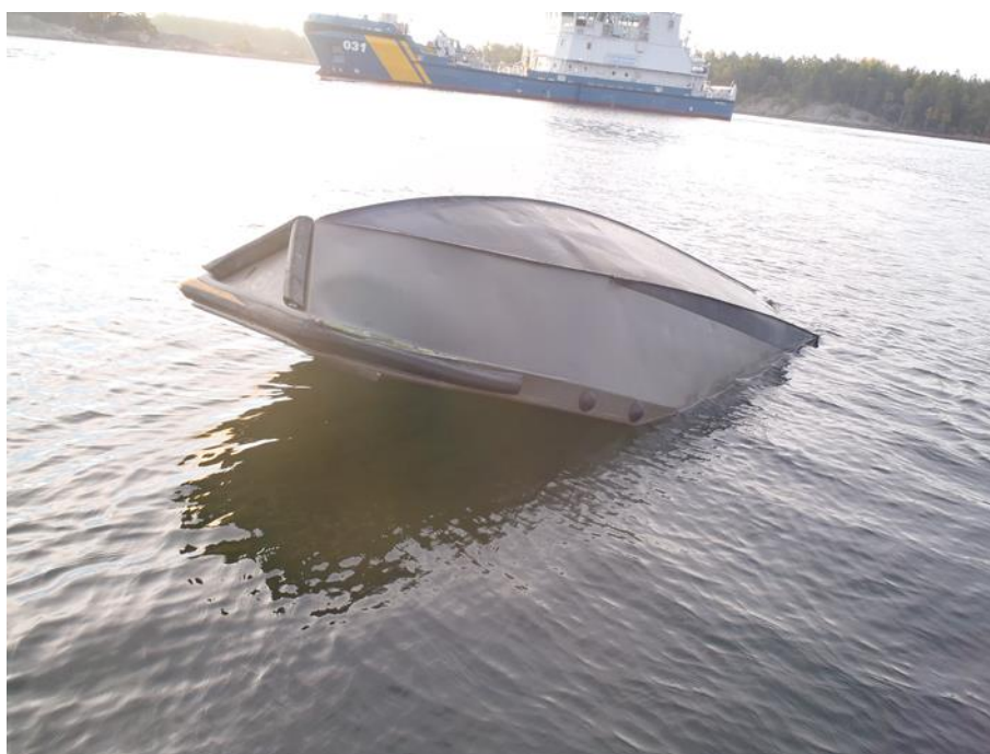
Figur 9. G-båtens flytläge i samband med bärgning. Foto: KBV.
