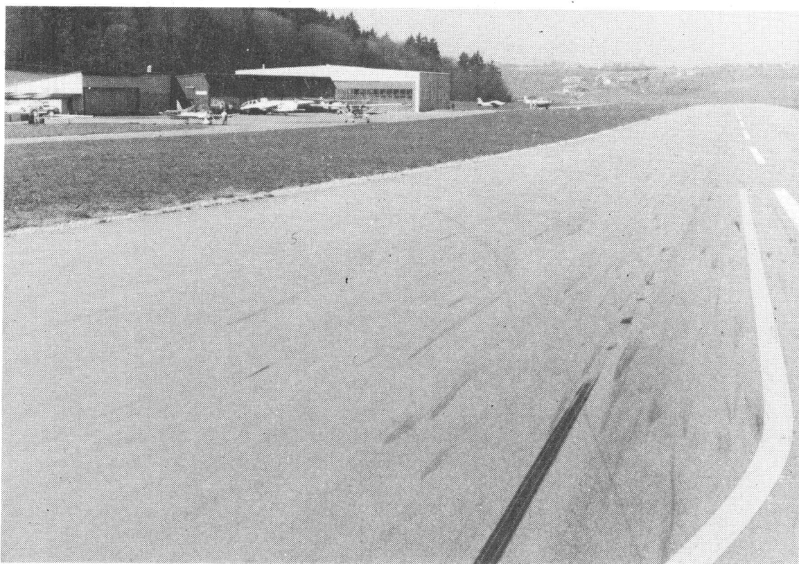
Même légende, mais vue prise quelques mètres plus loin. La première trace de ripage, celle de la roue de pouce, quitte la piste 225 m. après le seuil de piste et 125 m. après que l'avion eut pris contact avec le sol.
