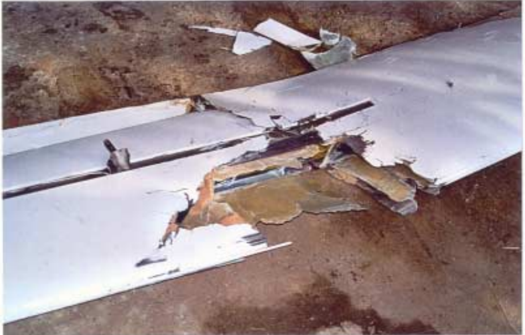
Segelflugzeug N° 1 : abgerissener rechter Flügel
