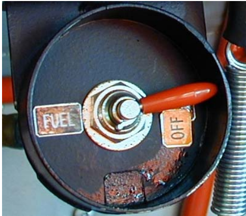
Fig.1: Benzinhahn in der Stellung „ON“, aufgenommen kurz nach dem Unfall. „OFF“ Beschriftung irreführend in der falschen Position.
