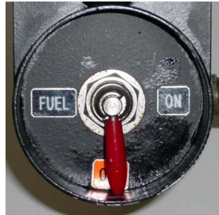
Fig.2: Benzinhahn in der Stellung „OFF“. „OFF“ Beschriftung zur Aufnahme in der richtigen Position angebracht.
