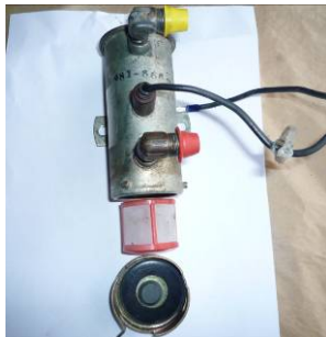
Fig. 3: Pompe à essence électrique du HB-UBI.
