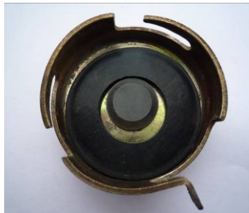
Fig. 4: Joint défectueux et non-conforme.
