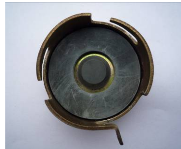
Fig. 5: Joint conforme selon le constructeur, p/n 479136.
