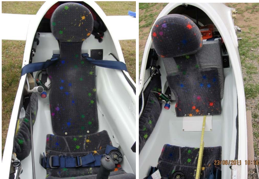
Abbildung 1: Fotos mit dem Cockpit einer äquivalenten DG-800 S: linkes Bild mit der Rückenlehne der Werksausführung in der vordersten möglichen Position, rechtes Bild mit der abgeänderten Rückenlehne der HB-3253 und mit dem Keilkissen, das beim Unfallflug hinter der Rückenlehne mitgeführt wurde
