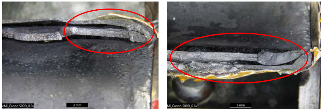
Fig. 7: Demi-surfaces de rupture A. Dans les zones entourées, les faces de rupture avec les possibilités restreintes de caractérisation
