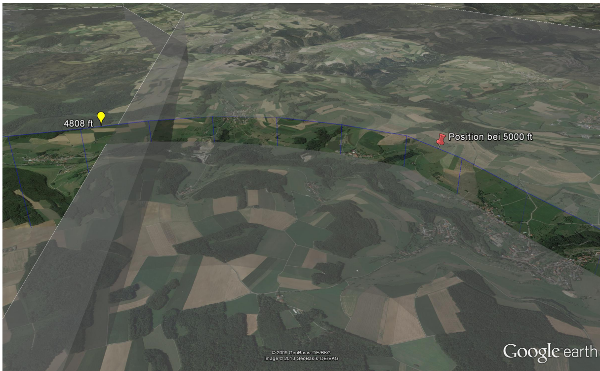
Abbildung 20: Beispielflugweg aus der Untersuchung mit einer Position (rote Nadel) innerhalb der TMA LSZH 2 beim erstmaligen Unterschreiten der Flughöhe von 5000 ft QNH und der Flughöhe beim Durchflug (gelber Tropfen) der Grenze zwischen TMA LSZH 2 und TMA LSZH.
