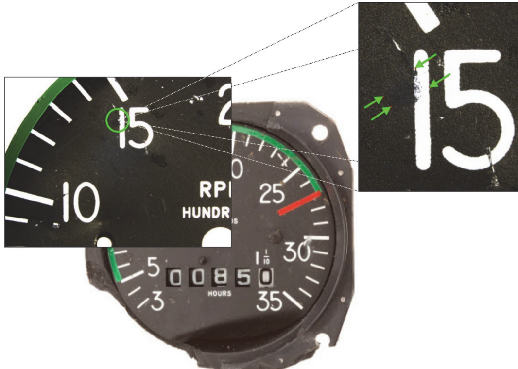
Abbildung 7: Drehzahlmesser mit Details. Grüner Kreis bzw. grüne Pfeile zeigen auf die Spur.
