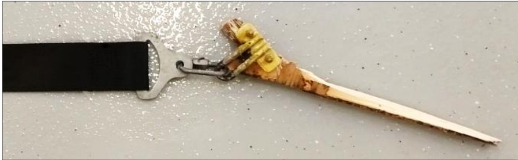
Abbildung 6: Aus der Flugzeugstruktur herausgerissenes Holzsegment mit dem hinteren rechten Beckengurt und intakter Schraubverbindung
