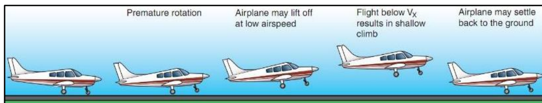
Abbildung 7: Abheben mit geringer Geschwindigkeit im Bodeneffekt (Quelle: Airplane Flying Handbook FAA-H-8083-3A)
