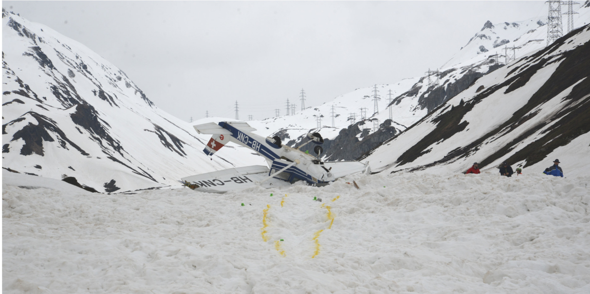
Abbildung 2: Endlage der HB-CNK, gelb gekennzeichnet die Aufprallspuren der vorderen Rumpfpartie; Bild aufgenommen drei Stunden nach dem Unfall in westlicher Blickrichtung zum Nufenenpass.
